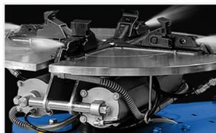
Una ráfaga directa de aire comprimido pasa a través de las mordazas de sujeción para facilitar el Asentamiento del talón.
