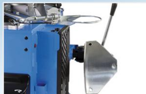
Un destalonador de pala lateral convencional, que cuenta con un control de pedal colocado ergonómicamente situado a una pequeña distancia del talón de la pala, es la solución más rápida para manejar eficientemente una variedad de neumáticos.
